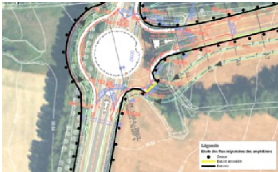
Plan pour la pose de la barrière à amphibiens autour du rond point (rocade sud Château-Gontier) - source MNE
